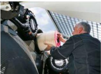
Troca de filtro de ar sem ferramentas
