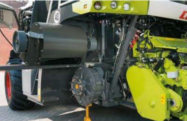
Fácil remoção e instalação do acelerador
